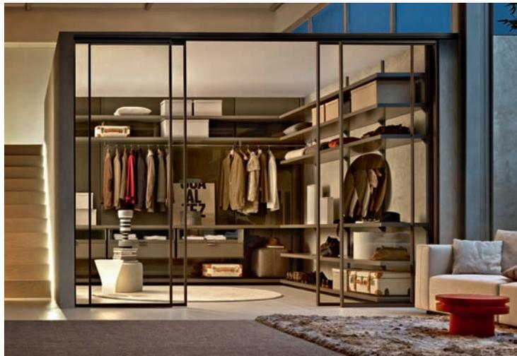
Dwell è un sistema di porte scorrevoli e pareti divisorie progettato per chiudere i vani delle cabine armadio Gliss Walk-In e per suddividere ambienti. Il sistema prevede binari di scorrimento a 1 e 2 vie entrambi utilizzabili in tre differenti situazioni di fissaggio: a soffitto, a parete laterale e ad incasso in presenza di un controsoffitto. Pareti e porte hanno telaio in alluminio anodizzato e nella esclusiva finitura brown, i vetri sono trasparente extrachiaro, fumè e stopsol.
