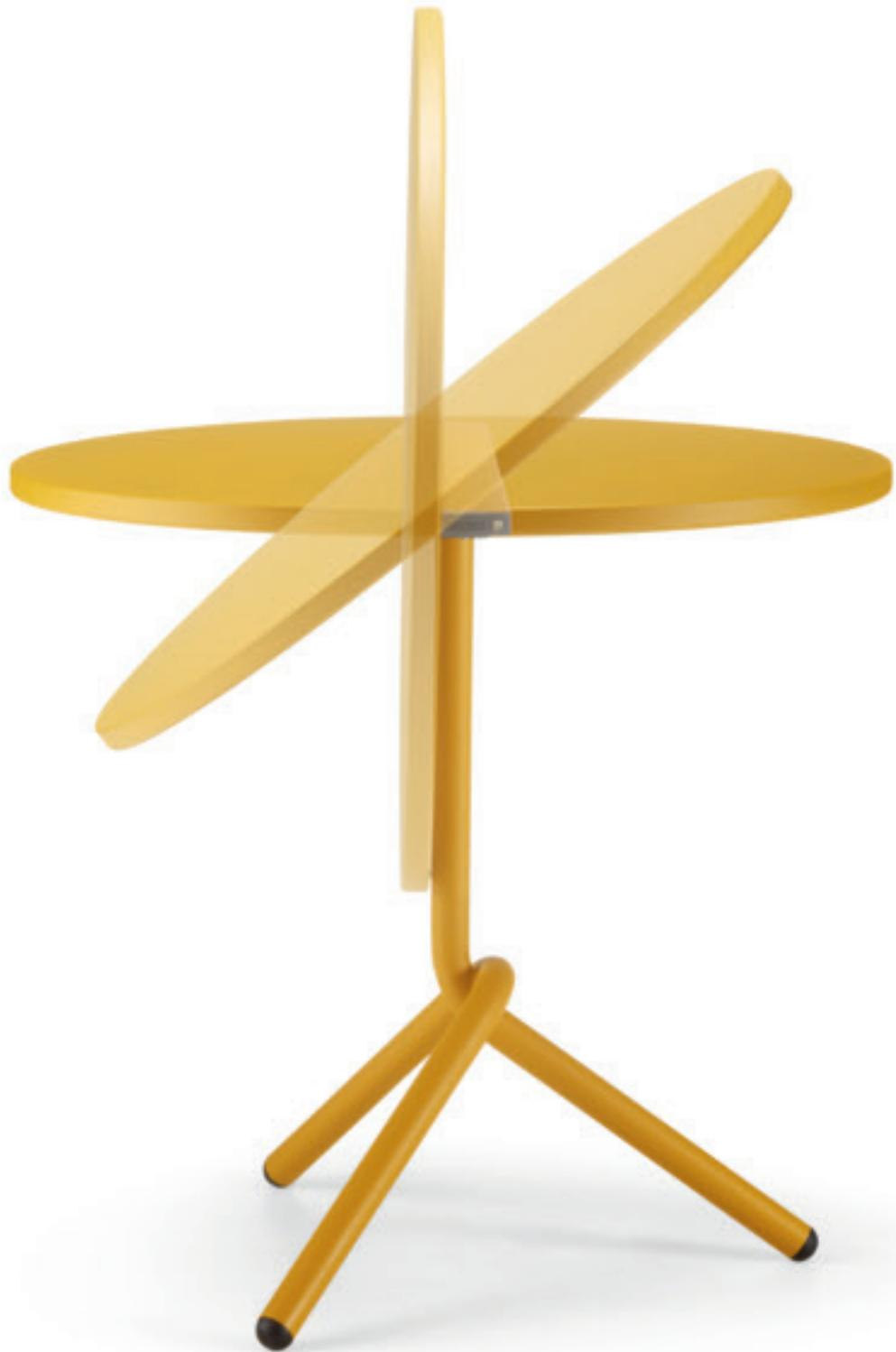
Il meccanismo di chiusura del top, per il quale è stato ottenuto un brevetto, è stato progettato per permettere al top di passare agevolmente dalla posizione orizzontale a quella verticale e viceversa. Grazie anche alla conformazione della base a piede triplo, i tavoli in posizione chiusa possono essere così impilati in orizzontale praticamente all'infinito, risolvendo problemi di spazio nei casi che lo richiedono.
